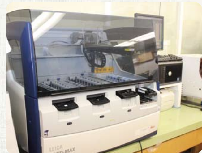
●免疫染色標本自動免疫染色装置 30枚まで染色でき、トレー（10枚）ごとに時間差で染色できるため、多くの染色オーダーを当日中に処理しています。
